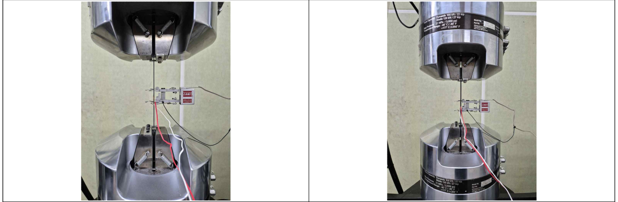
[ 복합재료 섬유방향 0/90도의 기계적인 물성 시험 ]
