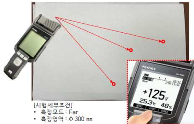
[정전기력 측정 시험기기 및 방법]
