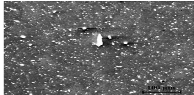
[ 나노복합재 SEM 이미지 (코팅 표면 위 zirconia 입자들) ]
