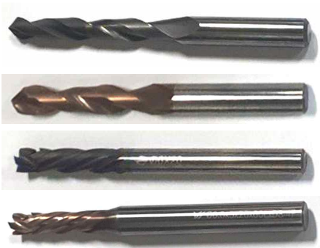
[ 위에서부터 DLC 코팅, TiAlN 코팅, DLC 코팅 이중나선 엔드밀, TiAlN 코팅 이중나선 엔드밀 ]
