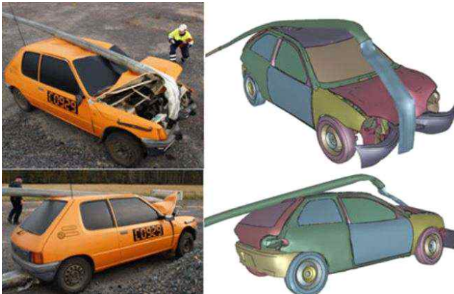
[ LS-DYNA를 이용한 차 파손 모델의 예시 ]
