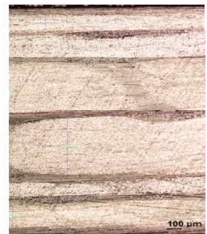
[ 복합 차체 라미네이트 단면적 (c) RCF1-A, (d) RFC1-B ]
